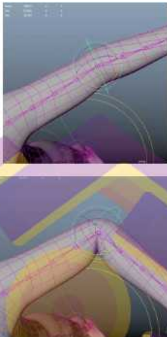
Gambar 4. 9 Rotasi FK pada elbow (B) mempengaruhi posisi tangan (A)
